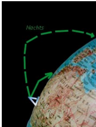
Mittelwelle Ausbreitung bei Tag kurz
