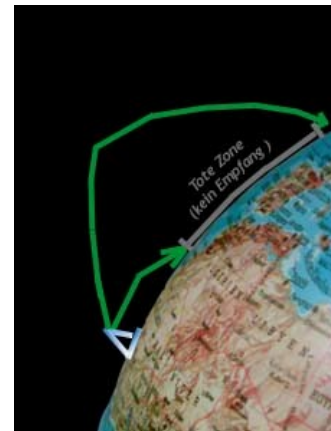
Kurzwellen Ausbreitung Bodenwelle ist kurz dann kommt die Tote Zohne .
